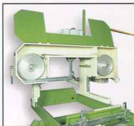
Timber Queen S testata di taglio con sportello aperto cabezal de corte con portillo abierto
