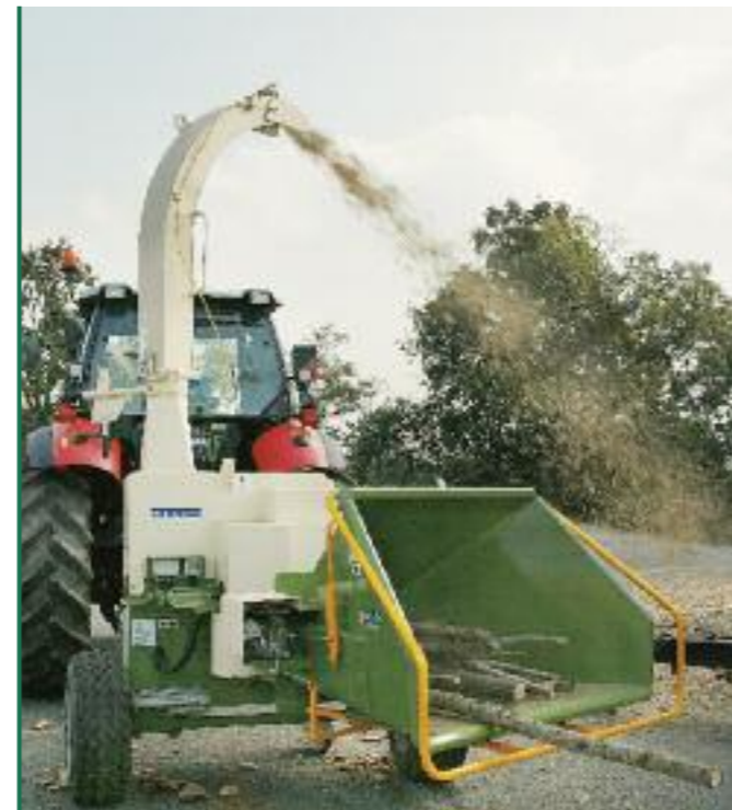
Modell H 880/250 beim Aufarbeiten von Astwerk.
