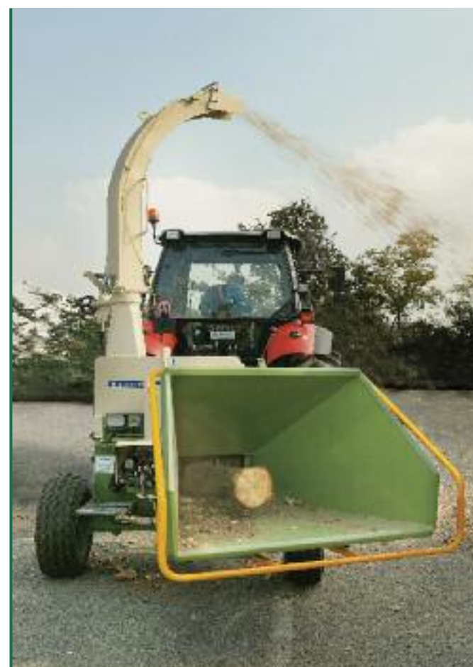
Il cippatore H 880/250 può cippare tronchi fino a 25 cm di diametro.
