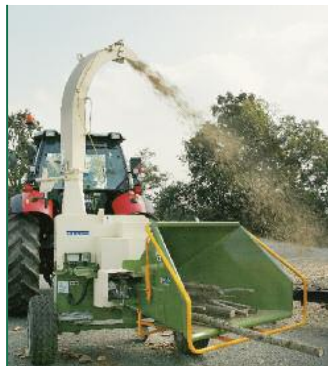
Il cippatore H 880/250 al lavoro con piccoli tronchi e ramaglie.
