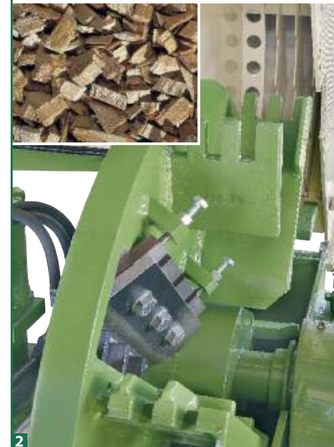
Détail sur l'ouverture d'alimentation du matériel. Sur le fond, sont visibles les rouleaux d'alimentation et, en second plan, le disque équipé d'un couteau broyeur. La vitesse des rouleaux peut être réglée par l'opérateur, selon le type de matériel à broyer.
