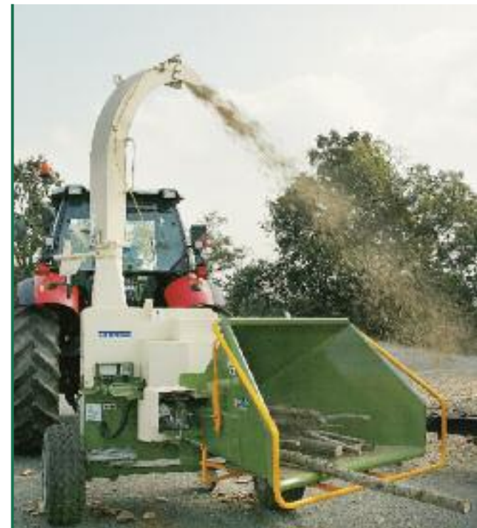
Le broyeur H 880/250 au travail avec un multiple de petit bois
