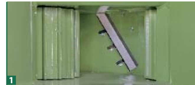
Détail sur l'ouverture d'alimentation du matériel. Sur le fond, sont visibles les rouleaux d'alimentation et, en second plan, le disque équipé d'un couteau broyeur. La vitesse des rouleaux peut être réglée par l'opérateur, selon le type de matériel à broyer.
