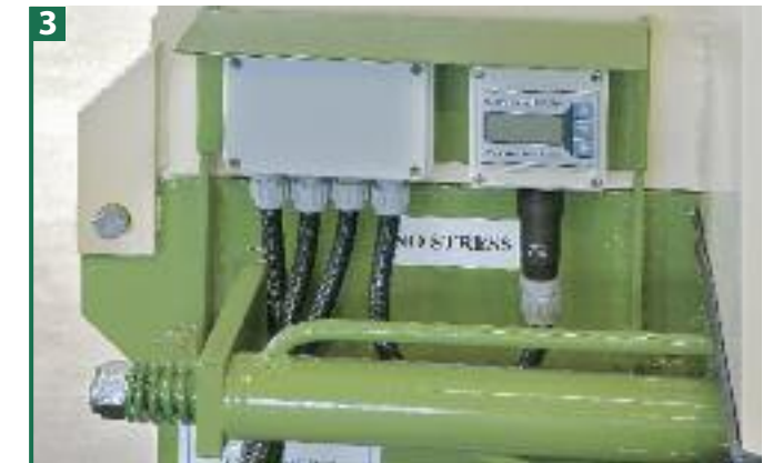
Le dispositif électronique "no stress" règle l'alimentation du matériel à broyer, en fonction de la puissance disponible, éliminant ainsi les efforts de force.
