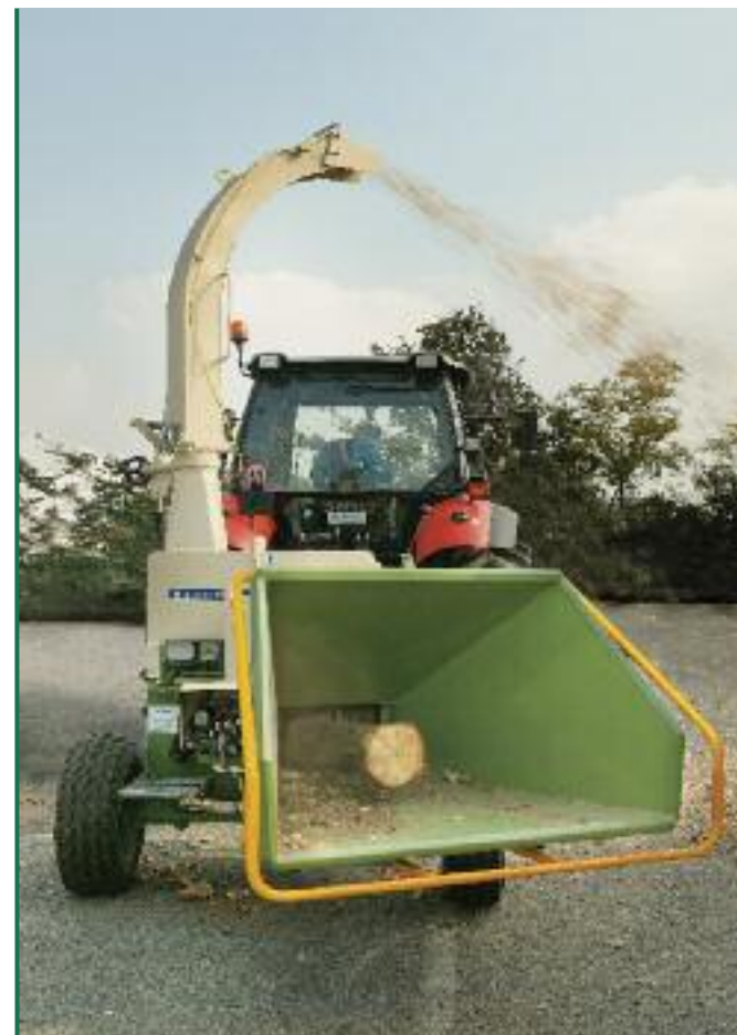
Le broyeur H 880/250 peut déchiqueter troncs jusqu'à 250 mm de diamètre.
